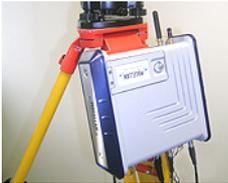
Dans le cas de levés topographiques, le ProFlex 800 peut être utilisé comme base temporaire, monté sur un trépied grâce à l'attache de fixation située sous le récepteur permettant sa fixation sur un des pieds.
