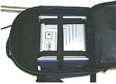
Le ProFlex 800 se fixe dans un sac à dos lorsqu'il est utilisé en tant que mobile devant effectuer des levés topographiques.
