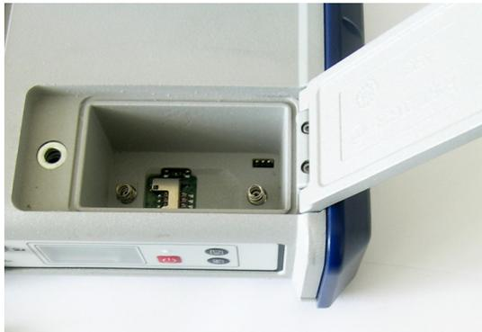
La batterie du ProFlex 800 est une batterie rechargeable de 7,4 V DC - 4600 mAh. C'est un modèle standard que l'on trouve dans de nombreux caméscopes.
